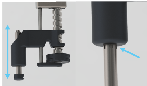
c) Verificare la scorrevolezza dell'asta di sicurezza facendola andare verso l'alto e verso il basso. Quando il movimento è privo di attrito, i punti di controllo saranno visibili.
