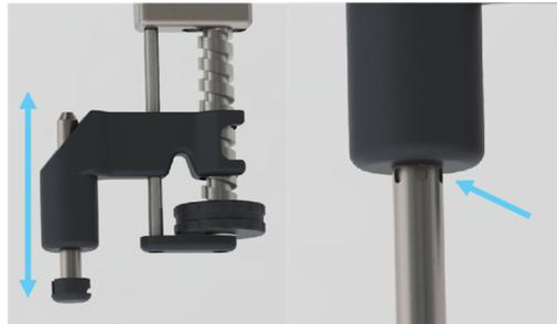
c) Vérifiez la liberté de mouvement de la tige de sécurité en la faisant glisser vers le haut et vers le bas. Lorsque le mouvement est libre, les repères de contrôle sont visibles.
